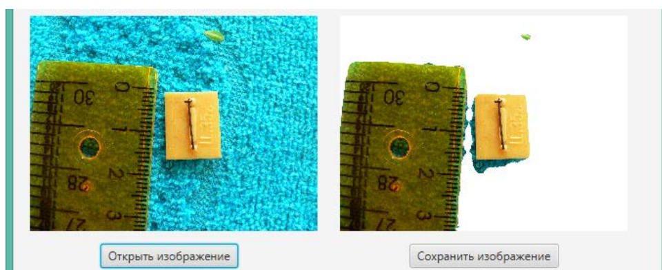
Рис. 3. Результат сегментации (размер матрицы свертки равен 80)
