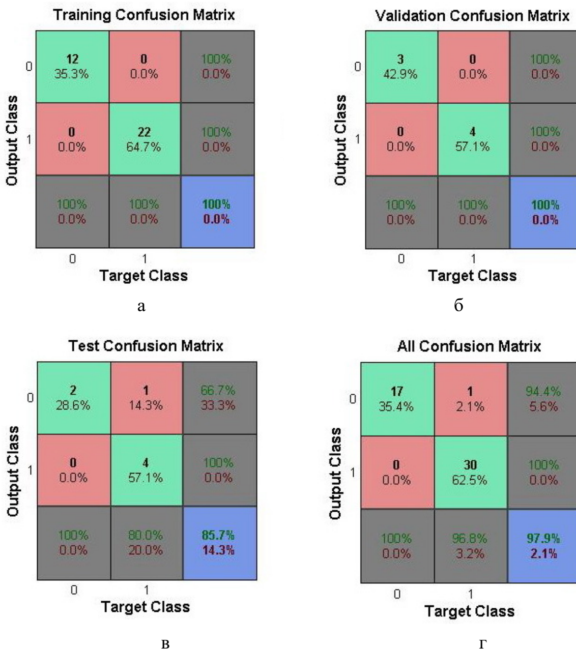
Рис. 3. Матрица соответствия – попадание данных в соответствующие группы данных: а – для обучающей выборки; б – для подтверждающей выборки; в – для тестирующей выборки; г – по всем данным совместно
