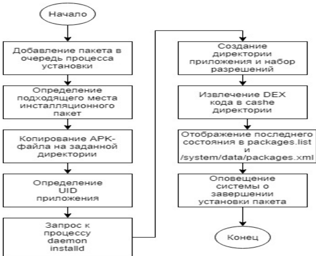
Рис. 2. Процесс установки приложение на Android – устройстве
