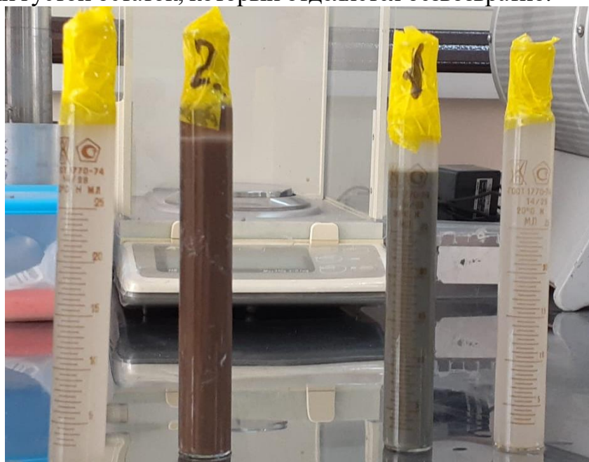
Рис. 1. Щелочной раствор и суспензия из вулканического туфа (справа) и кварцевых песков (слева)
