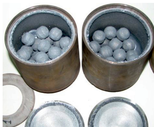
Рис. 1. Вид внутреннего пространства мельничного стакана и шаров с обрабатываемым материалом. Длительность обработки 60 минут
