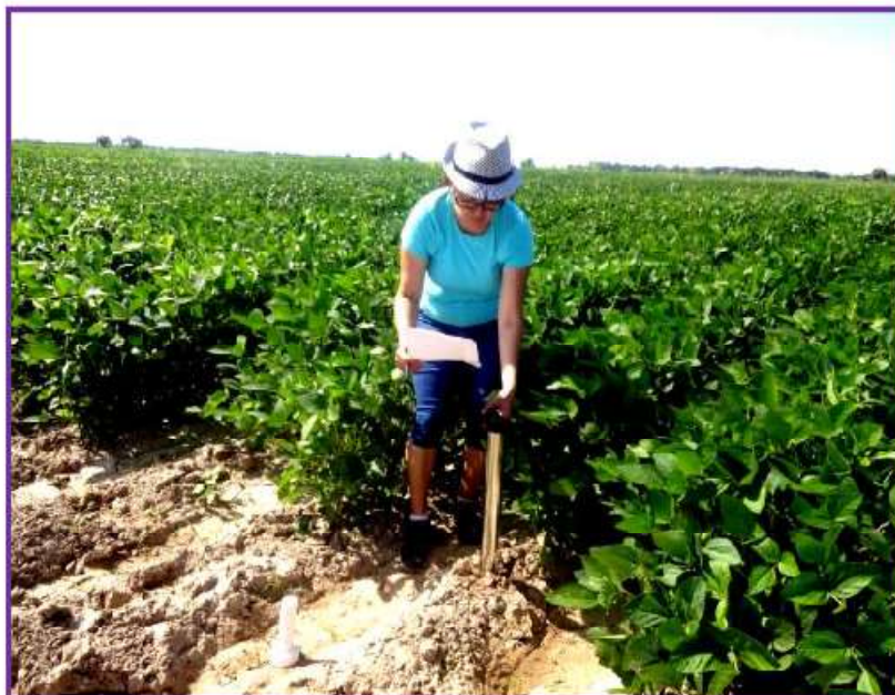
Рис. 4. Выполнение мониторинга гидрохимического режима грунтовых вод в наблюдательной скважине на площадке № 2
