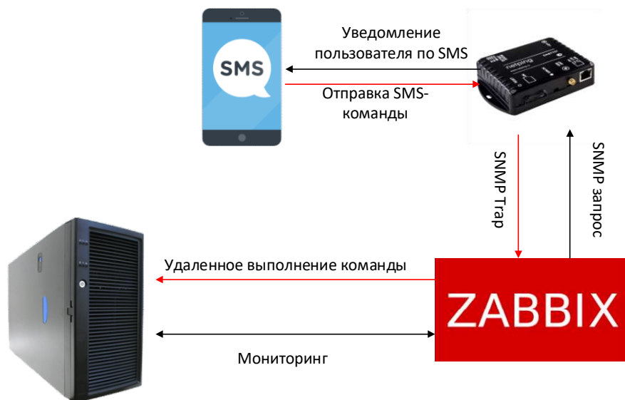
Рис. 2. Общая схема системы управления сетевыми устройствами
