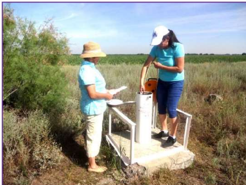
Рис. 3. Замер уровня грунтовых вод в мониторинговой скважине №503-К
