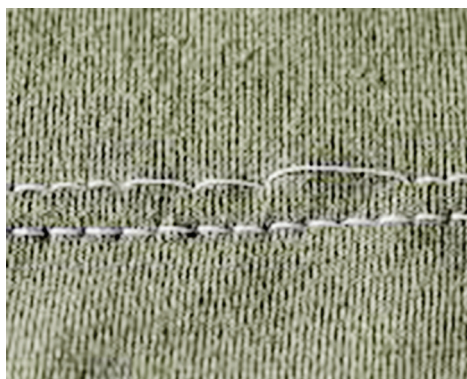
Рис. 1. Внешний вид строчки при нарушении процесса петлеобразования
