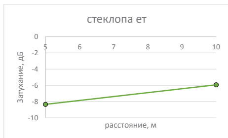
Рисунок 3 – График зависимости затухания от расстояния (стеклопакет)
