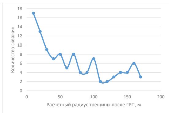
Рисунок 1 - Распределение скважин в зависимости от расчетного радиуса трещин, полученных при ГРП.
