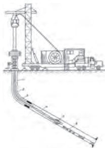
Рис. 1. Оборудование, применяемое при ловильных работах колонны
