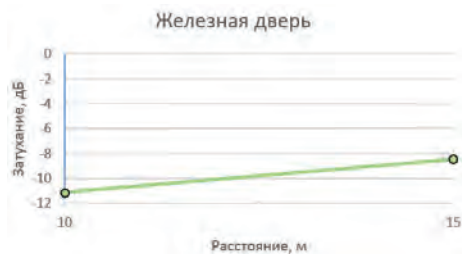
Рисунок 2 – График зависимости затухания от расстояния (железо)
