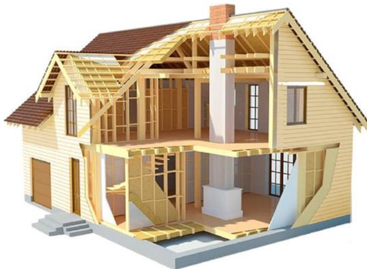
Рис. 2. Устройство каркасно-щитового дома
