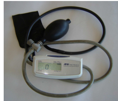
Рис. 3.2. Пневматический прибор для измерения давления одежды на тело человека.
